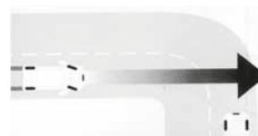
**Si las Ruedas Traseras Traban:** el vehículo pierde estabilidad y puede derrapar. Una mala aplicación o desgaste de las pastillas delanteras, o también un defecto en los caballetes del freno delantero, puede ser la causa.
