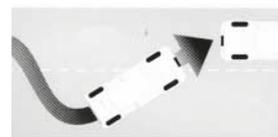
**Estabilidad y Derrapar:** el vehículo puede mantener su trayectoria en las frenadas. Cuando esto no ocurre, hay falla en uno de los lados del sistema de frenos, pudiendo ser: pistones de los cilindros trabados, discos defectuosos o gastados, pastillas con aplicación errada, desgastadas, con aceite o cristalizadas.
